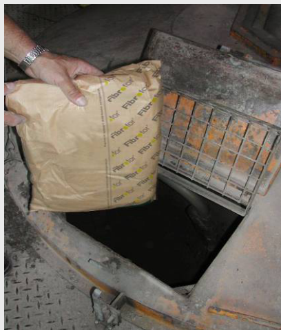
Dodavanje na betonari
